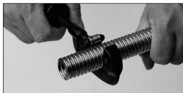
1. Schlauch auf gewünschte Länge im Wellental mit einem Rohrschneider ablängen
