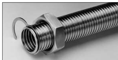
6. Klemmring in das erste Wellental einlegen und zu einem geschlossenen Ring zusammendrücken. Dichtung einlegen, Einschraubteil aufsetzen und mit zwei Sechskantschlüsseln anziehen.
