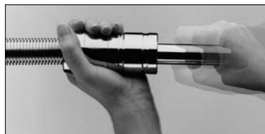
4. Klemmbacken schließen. Durch Bewegen des Schlagbolzens die Welle zu einem Bündel anstauchen.
